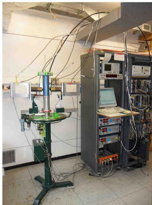
Abbildung 41: Versuchsaufbau zur Bestimmung biaxialer Verspannungen. Die Probe wird über eine Halterung in den Dewar eingebracht. Dieser ist zwischen den Detektoren der Dreidetektoranlage platziert und kann mit flüssigem Stickstoff befüllt werden.
