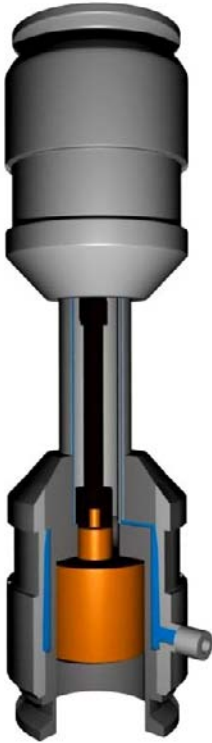
Abbildung 3.7: Schematischer Aufbau der Heizvorrichtung. Der braun dargestellte Graphitheizer, in den das Glasröhrchen mit der Probe eingeführt wird, ist an zwei Elektroden befestigt (orange). Um die Detektoren vor Hitzeabstrahlung zu schützen wird die Aluminium-Ummantelung durch einen Wasserkreislauf (blau) gekühlt. Damit der Abstand der Detektoren zur Probe gering ist, wird die Aluminiumhülle möglichst dünn gehalten.
