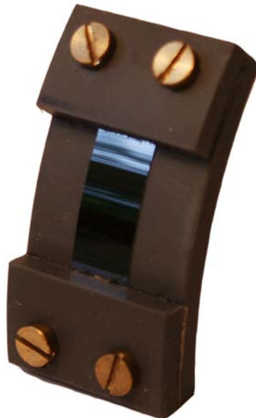
Abbildung 3.6: Der neue Probenhalter aus PVC
