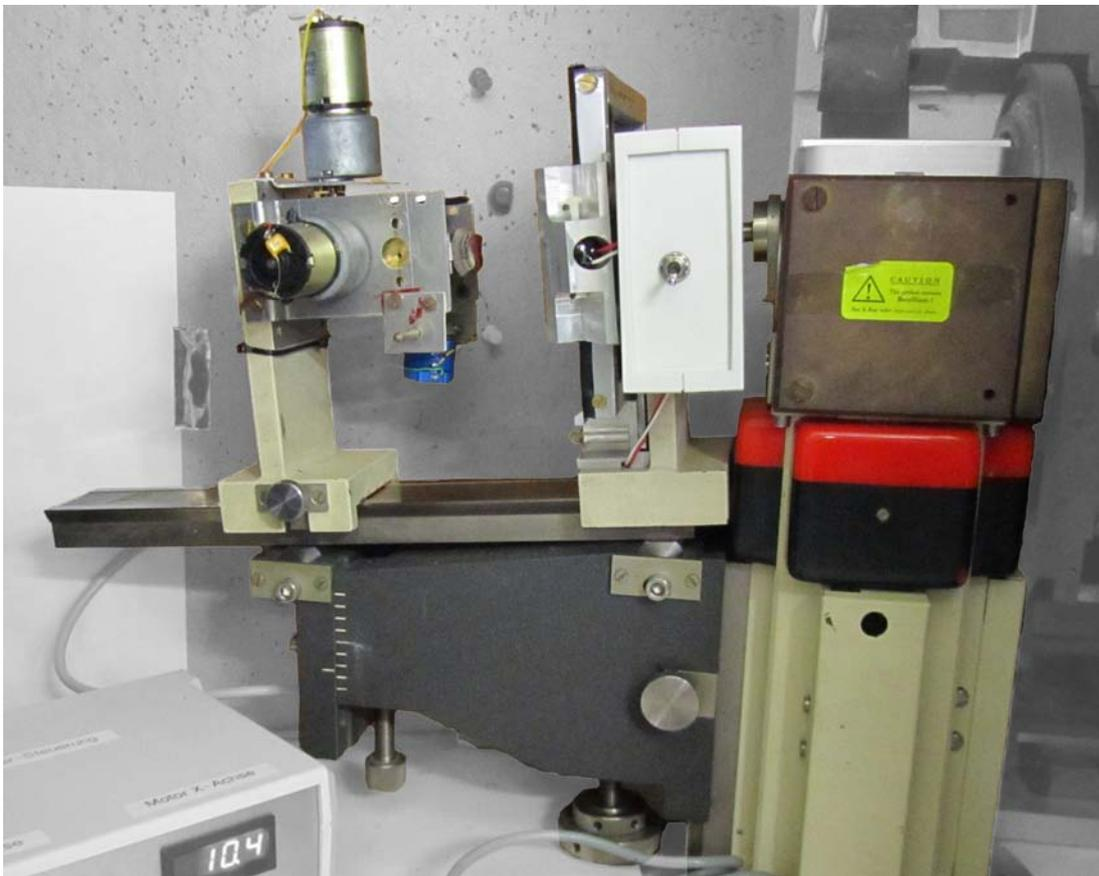
**Fig. 5.1:** Foto der Anlage zur Kristallorientierung mit Hilfe des Laue-Verfahrens aus Labor K55
