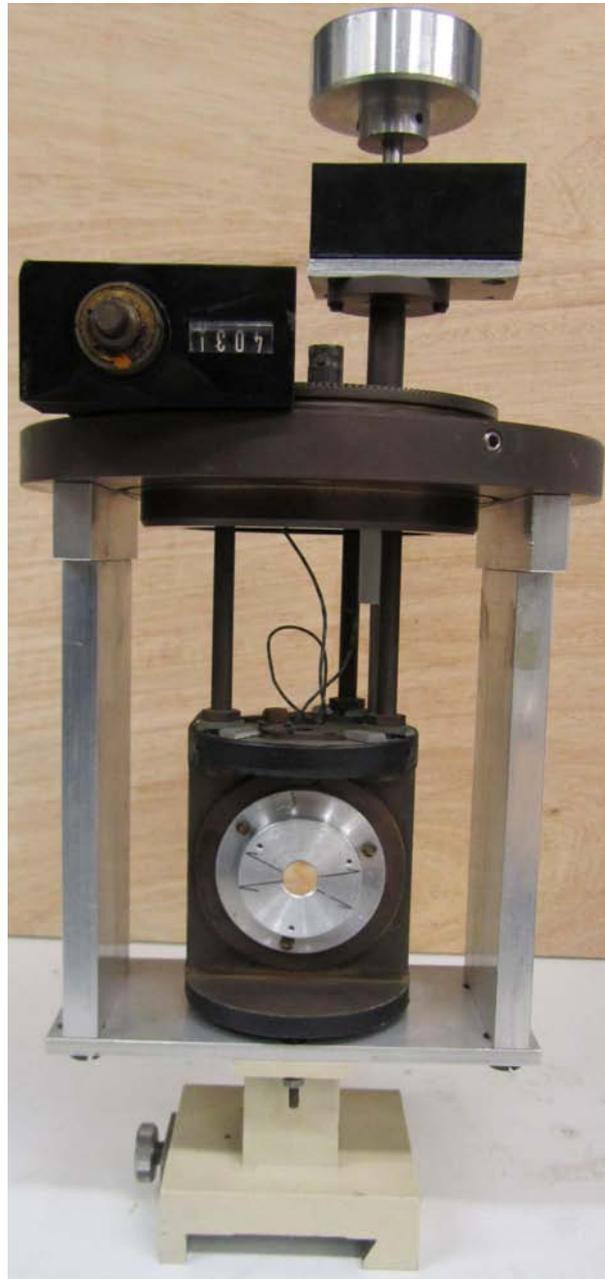
**Fig. 3.4:** Goniometer mit Zählwerk für Winkeleinstellungen
