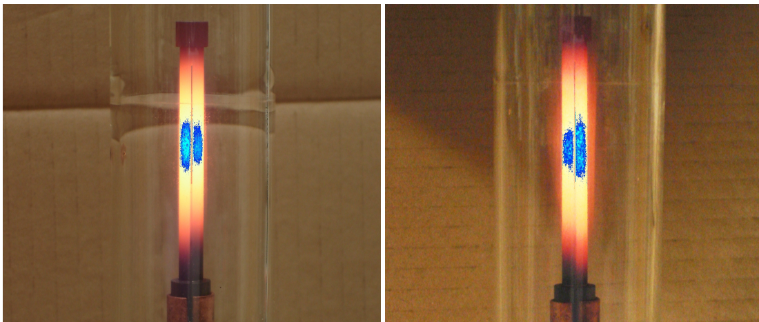
Abbildung 3.6: Die Temperaturasymmetrie des Heizers. Die hellsten und damit heißesten Regionen sind in Falschfarben dargestellt, absteigende Helligkeit der blauen Farbe bedeutet weniger helles Leuchten des Heizers. Beide Fotos zeigen den selben Heizer, der auf dem zweiten Bild um 180^{\circ} gedreht montiert ist. Auf beiden Bildern ist zum einen zu erkennen, dass eine Seite des Heizers heißer wird und dass der heiße Bereich in der Mitte des Heizers breiter ist. Zum anderen ist der im optischen Bereich leuchtende Teil auf einer Seite kürzer. Beide Fotos sind mit ISO 200 aufgenommen.
