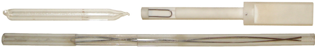
Abbildung 2.11: Die drei genutzten Probenhaltervarianten. Oben links, eine zuge-schmolzene Quarzglasampulle für pulverartige, oder zu schmelzende Proben, oben rechts ein Macor-Probenhalter und unten ein Quarzglas-Probenhalter. Die beiden letzteren werden für einkristalline Proben genutzt.
