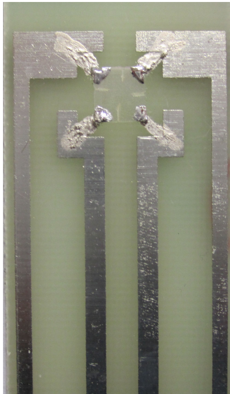
Abbildung 4.2.: Bild der kontaktierten Probe #1 auf einer Hall-Platine. Die GaIn-Kontakte und Einritzungen sind deutlich zu erkennen.
