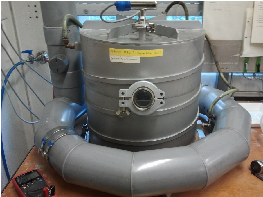
Abbildung 6.2: Die RTA-Anlage mit geschlossener Kuppel. In der Bildmitte ist das Quarzglasfenster zu sehen, durch das die Messung mit dem Pyrometer stattfindet.
